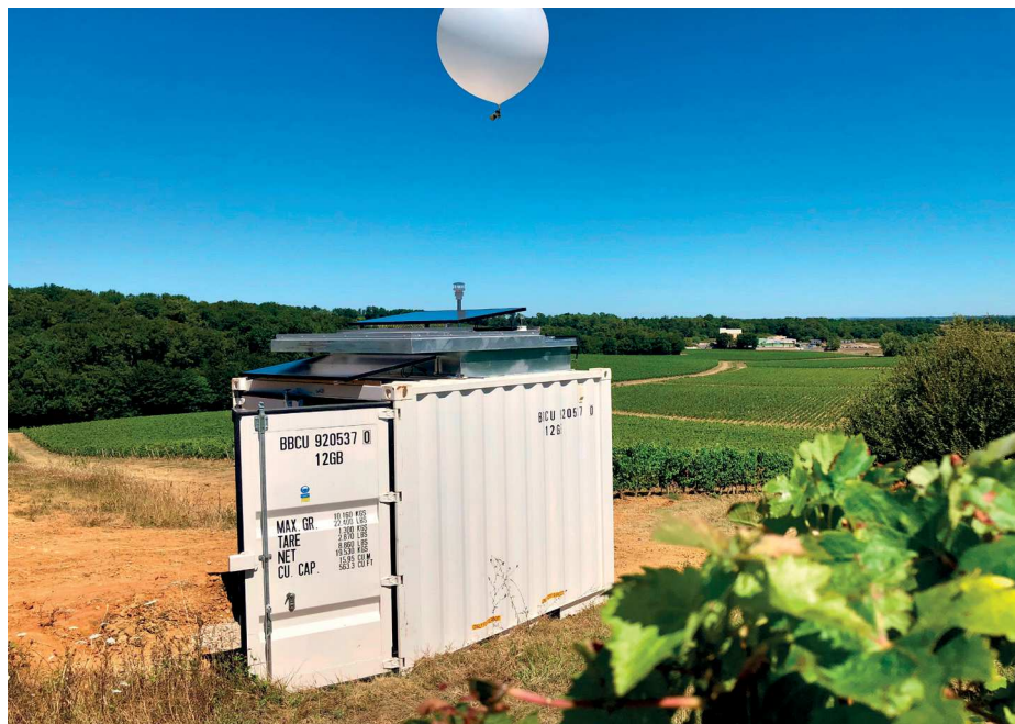
► Système de lutte collective contre la grêle mis en place par le Conseil des Vins de Saint-Émilion, avec lanceur télécommandé de ballons chargés de sels hygroscopiques.
